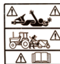
Gevaar van verstrikking met de aftakas - houd afstand van de aftakasaandrijvingen
