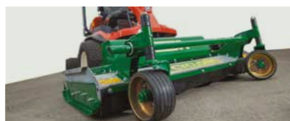
Sistema di regolazione dell'altezza di taglio da 10 a 110 mm
