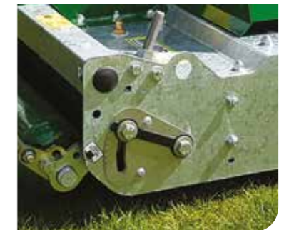
L'altezza di taglio è regolabile da 10 mm a 130 mm per la falciatura per tutto l'anno
