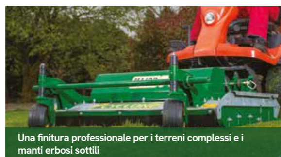
Sistema di regolazione dell'altezza di taglio da 10 a 110 mm
