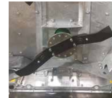
Sistema due lame in una: rigido e oscillante
