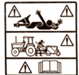
Danger d'enchevêtrement dans les prises de force - Restez à distance des transmissions de prises de force.
