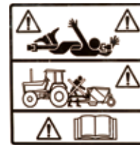
Danger d'enchevêtrement dans les prises de force – Restez à distance des transmissions de prises de force.
