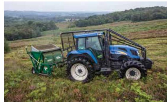
Les opérations d'entretien du rotor et des fléaux peuvent être effectuées lorsque le bac est en position haute, le verrouillage doit alors être enclenché afin de garantir la sécurité de l'utilisateur. Particulièrement robustes, ces faucheuses professionnelles requièrent une faible force de traction : un tracteur doté d'une puissance de 38 kW suffit pour une largeur totale de 2,20 m.
