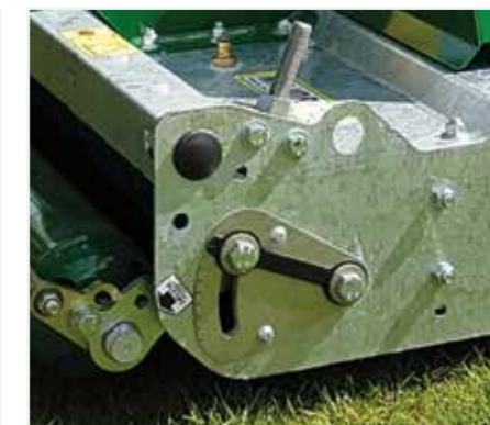
Système d'ajustement de la hauteur
