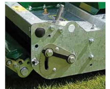
Système d'ajustement de la hauteur
