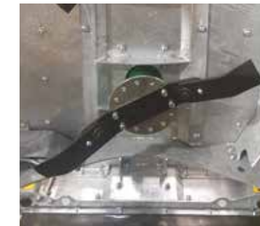
Twee messystemen in 1, vast mes of slingermes.
