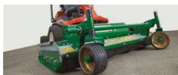
Maaihogte verstelling van 10-110mm
