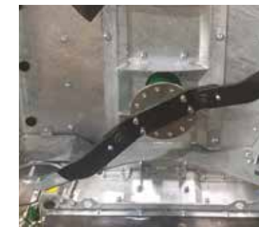
Twee messystemen in 1, vast mes of slingermes.
