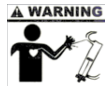
Gefahr des Verfangens mit der Zapfwelle - halten Sie Abstand von den Zapfwellen-Antriebssträngen
