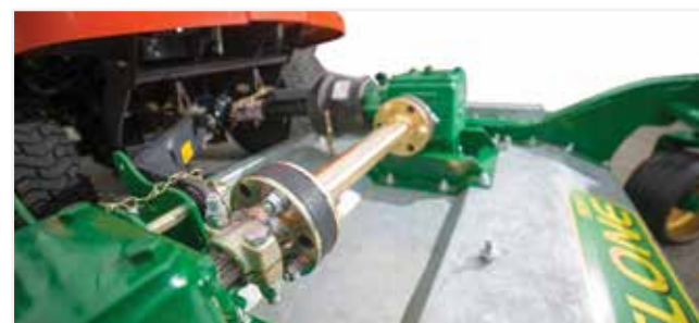
Robuste Bauweise und zahnradgetriebenes Messersystem
