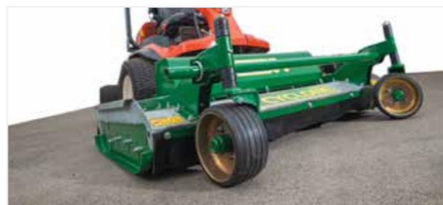
Schnitt Höhenverstellung zwischen 10 und 110mm
