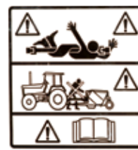
Fare for fastkøring i PTO – hold afstand til PTO-drev.
